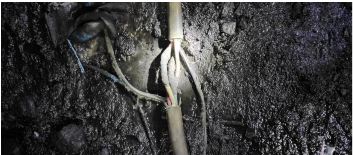
图 3 电缆挤伤处接头（其他两相为安全考虑，事故后连接包扎）
